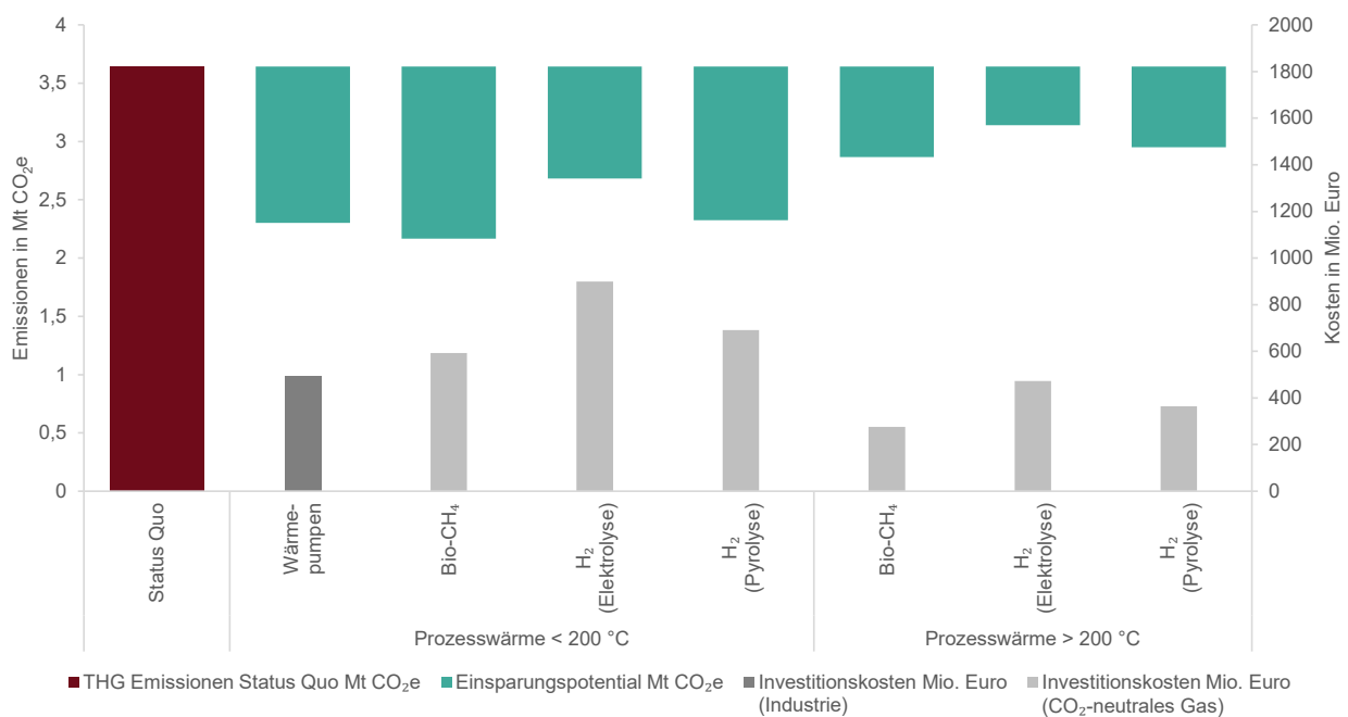
Abbildung 43: Zusammenfassung der CO 2 -Reduktionspotentiale und Investitionskosten in den nicht-energieintensiven Sektoren (Kosten in Mio. €)
